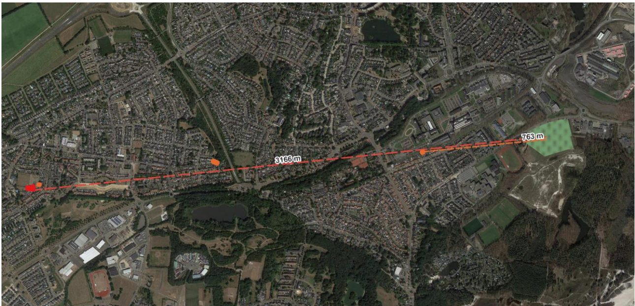
Figuur 25: Afstand van zonnepark tot middenspanning-transportverdeelstations (oranje) en hoogspanningsstation (rood).
